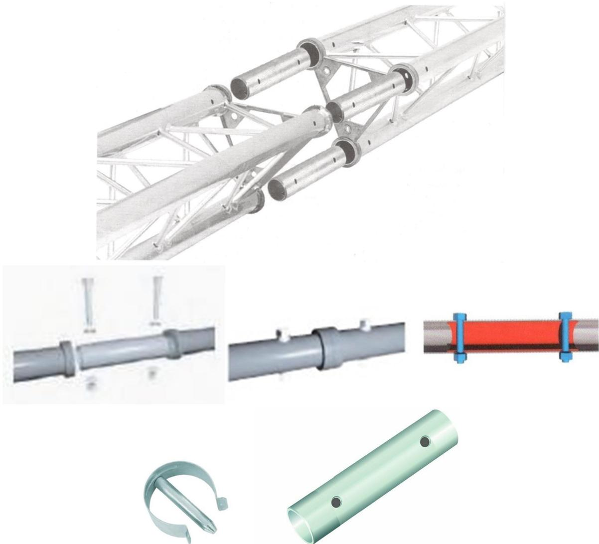
Generell werden die 3-Punkt Traversen mit einem Innenrohrverbinder und zwei M10 Schrauben verbunden. Als Alternative zu den Schrauben, gibt es einen Schnellverschluss bestehend aus einem Federbügel mit Dorn, der das Zusammensetzen der einzelnen Teile erheblich erleichtert. Besonders geeignet ist der Schnellverschluss bei häufiger Montage und Demontage.
